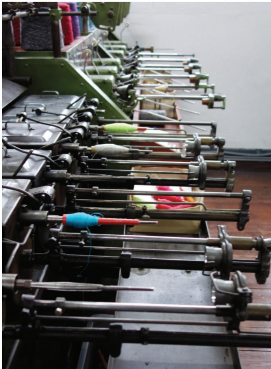
Spulmaschine mit Schusspulen
